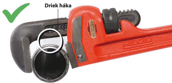
Obrázok 3 – Zachovávajúte medzeru medzi driekom háka a obrobkom
