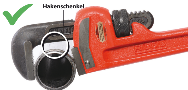
Abbildung 3 – Spalt zwischen Hakenschenkel und Werkstück lassen
