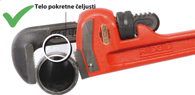
Slika 3 – Održavajte razmak između tela pokretne čeljusti i radnog komada
