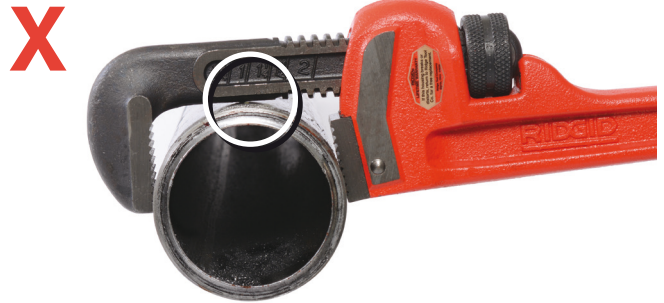
Εικόνα 4 – Πολύ μικρός σωληνοκάβουρας για το αντικείμενο εργασίας, το στέλεχος κινητής σιαγόνας αγγίζει το αντικείμενο.
