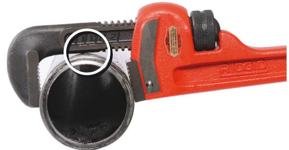
Figura 4 – Cheia prea mică pentru piesa de prelucrat, tija fâlcii mobile atinge piesa.
