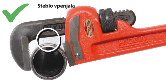
Slika 3 - Ohranite razmik med stebлом vpenjala in obdelovancem
