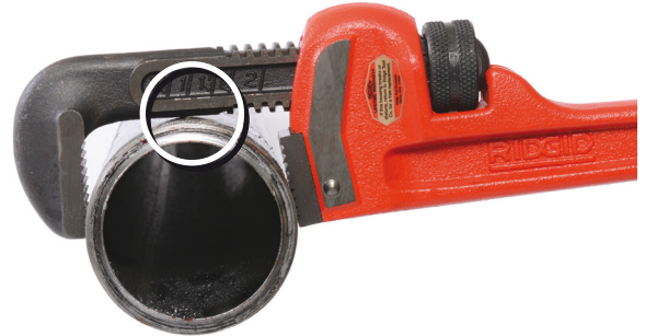
Obrázek 4 – Hasák je příliš malý pro opracovávaný kus, rameno háku se dotýká opracovávaného kusu.
