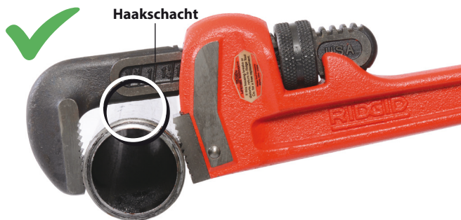
Figuur 3 – Houd altijd speling tussen de schacht van de haakse bek en het werkstuk
