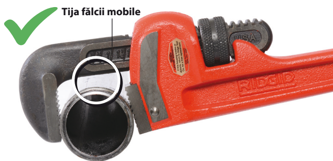
Figura 3 – Mențineți intervalul între tija fâlcii mobile și piesa de prelucrat
