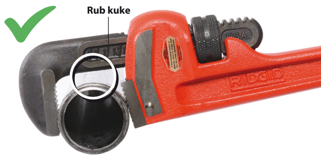
Slika 3 - Održavajte razmak između ruba kuke i radnog dijela
