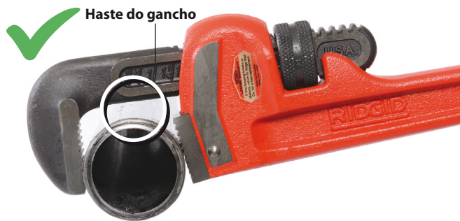
Figura 3 - Manter a folga entre a haste do gancho e a peça de trabalho
