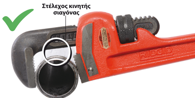
Εικόνα 3 – Αφήνετε κενό ανάμεσα στο στέλεχος της κινητής σιαγόνας και το αντικείμενο
