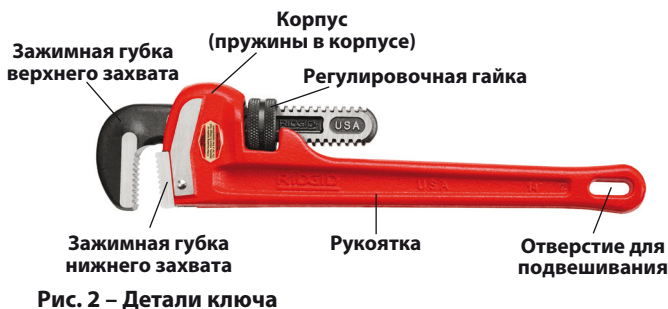
Рис. 2 – Детали ключа
