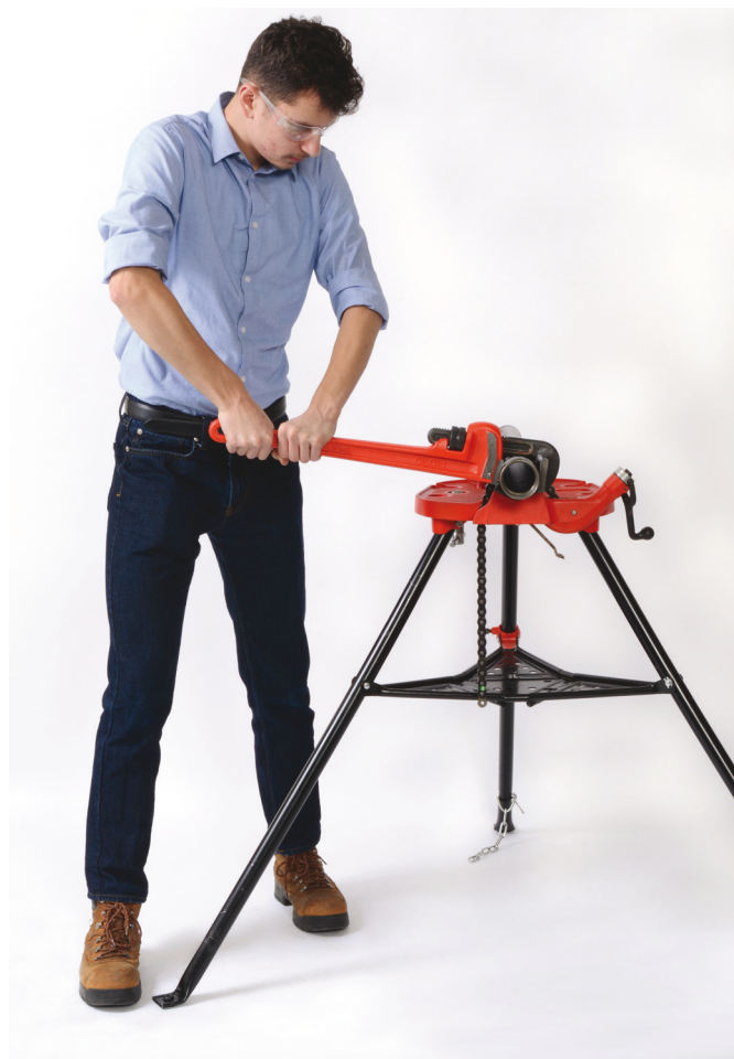
Figura 7 – O poziție de operare corespunzătoare
