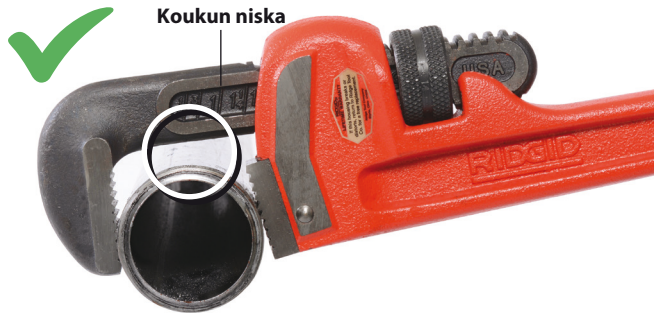
Kuva 3 – Pidä väli koukun niskan ja työkalupaleen välillä
