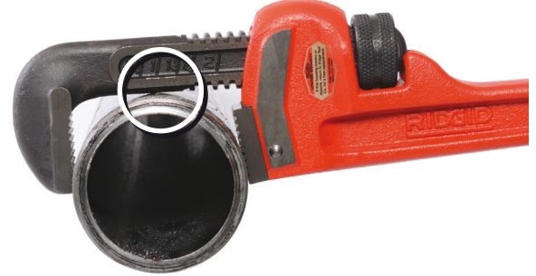
Şekil 4 - Anahtar İş Parçası İçin Çok Küçük, Kanca Sapı İş Parçasına Dokunuyor.
