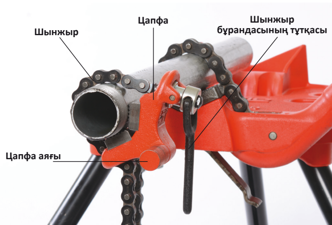
6A-сурет – Күрделі тетікті кілт цапфасын құбырға бекіту
