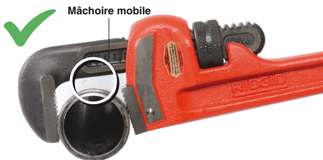
Figure 3 – Vide entre le bras de la mâchoire mobile et l'ouvrage
