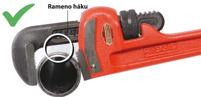
Obrázek 3 – Mezi ramenem hákem a opracovávaným kusem udržujte mezeru
