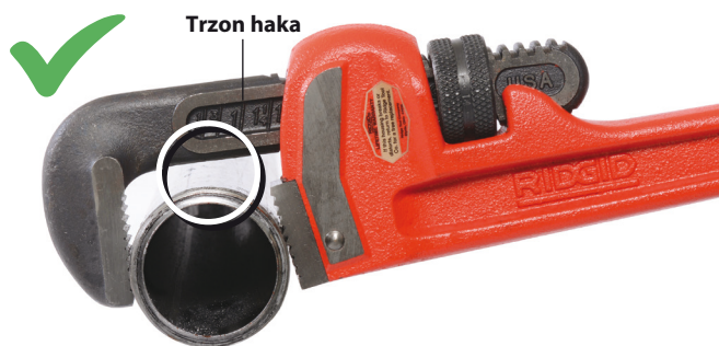
Rysunek 3 – Zachować odstęp między trzonem haka a elementem obrabianym
