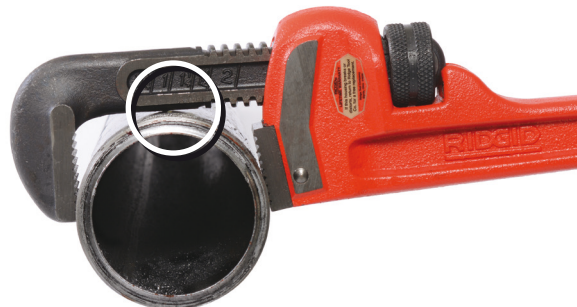
Figur 4 – Tangen for liten for arbeidsemnet, krokstammen berører arbeidsemnet.
