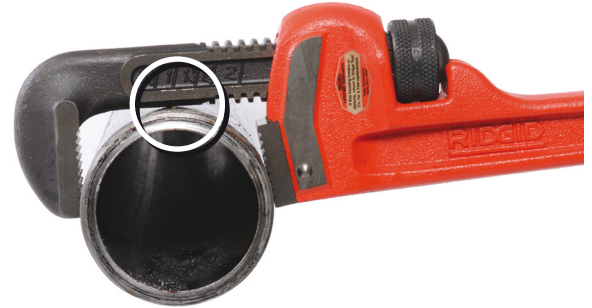
Kuva 4 – Työkappaleelle liian pieni avain, koukun niska koskee työkalupaleeseen.
