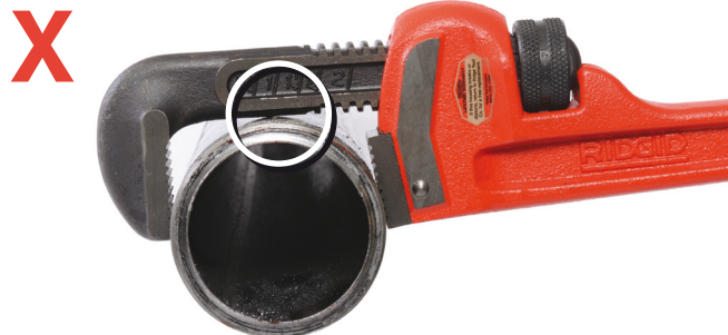
Figura 4 - Chave demasiado pequena para a peça de trabalho, haste do gancho a tocar na peça de trabalho.
