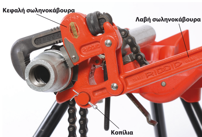
Εικόνα 6Β – Στερέωση λαβής στο δίχαλο
