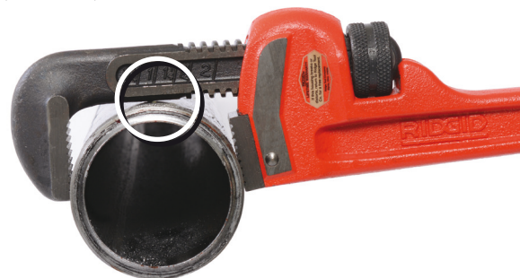
Рис. 4 – Ключ слишком мал для работы с изделием, хвостовик верхнего захвата касается изделия.
