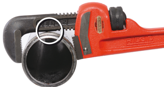
Slika 4 - Ključ premajhen za obdelovanca, steblo vpenjala se dotika obdelovanca.
