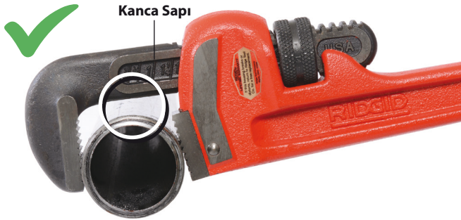
Şekil 3 - Kanca Sapı ve İş Parçası Arasındaki Boşluk Sağlayın
