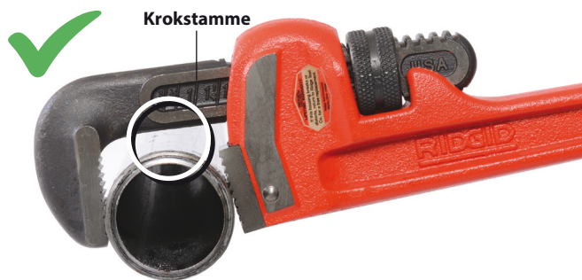
Figur 3 – Oppretthold mellomrommet mellom krokstammen og arbeidsemnet
